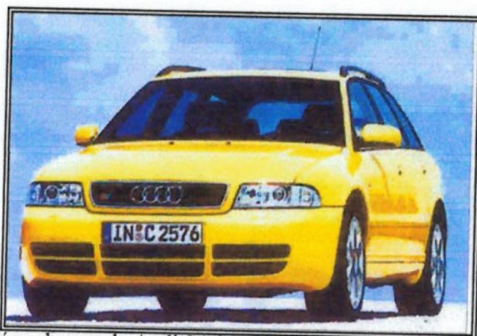
Fig 4.2 - Pára-choque de Audi S4 feitos em ABS+PA para resistir a temperaturas elevadas dos motores de alta potência
